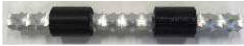
8mm□, リード 50mm ガウディネジ (アルミ): 切削 ナット (樹脂): 3Dプリンタ
