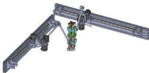
図5 平行ロボットの設計
