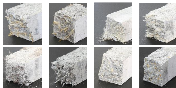
写真6 実験後の供試体断面の様子 (上段左から、ヤシ、竹、サイザル麻、麻、 下段左から、パームヤシ、綿、木くず、もみ殻)
