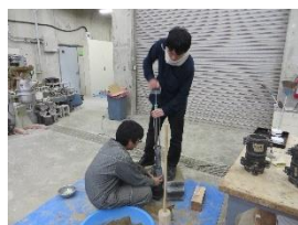
写真8 突き固めの様子
