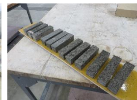
写真5 脱型後の供試体
