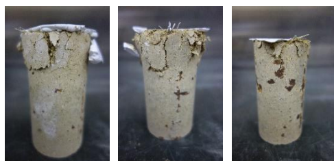
写真9 破壊後の供試体 (左から、藁、サイザル麻、竹繊維)
