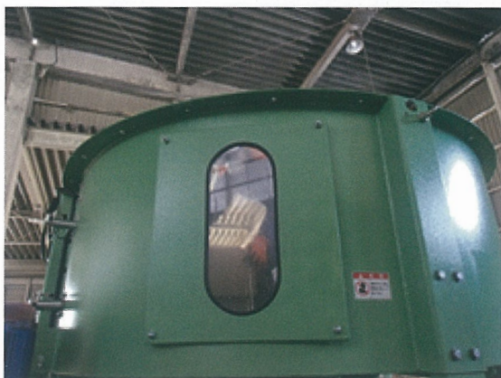
写真1 支持投入ホッパー
