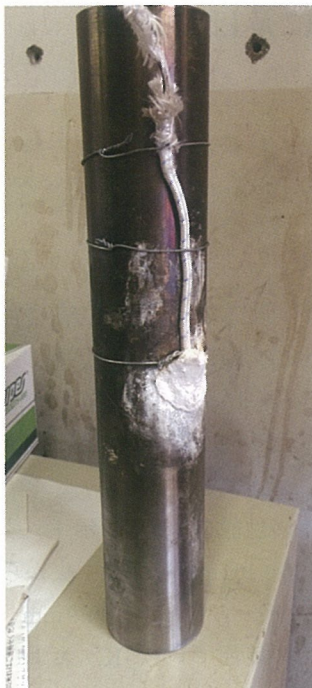
写真1 鋼製筒と熱電対 M の設置状況
