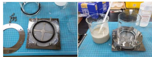
図2 ラボ用セルの下部電極(写真左)と組み立てたセルの全容(写真右)。
