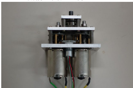
図5 ローコストなサーボ機構
