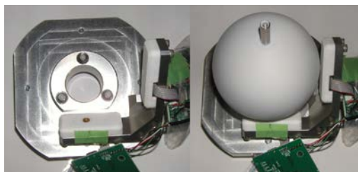
図 8 光学センサを使用した姿勢センサ
