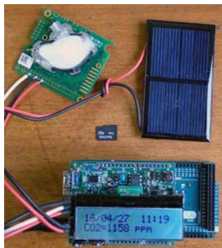
図3 計測用 Shield 利用の環境計測装置試作例
