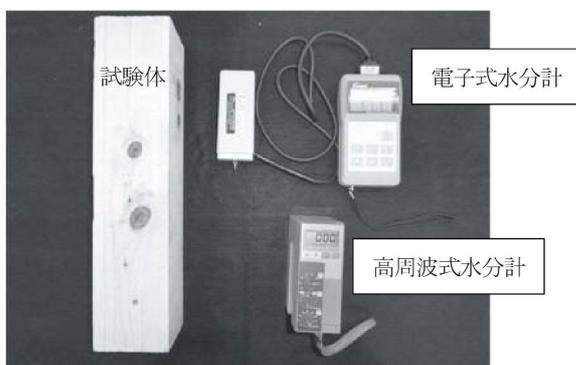
写真10. 木材水分計による含水率計測
