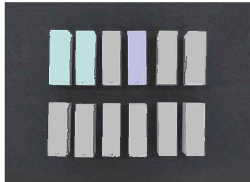
写真11. 縦圧縮試験体（12体）
