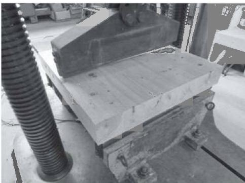
写真 16. ヒノキパネルのせん断試験 (試験体 2)
