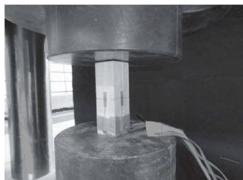
写真12. 圧縮試験装置
