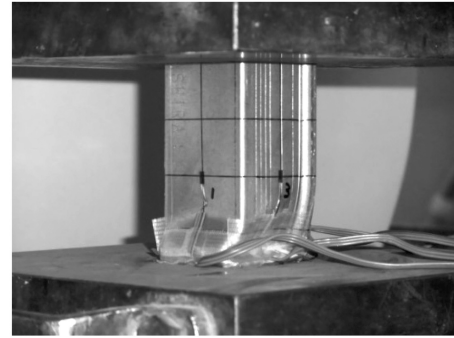
写真 4. 試験体 A-1 終局状況（板厚 1.2mm）
