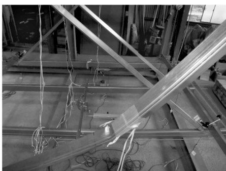
写真 8. 試験体 1-1 の終局状況 (ブレース材の座屈)
