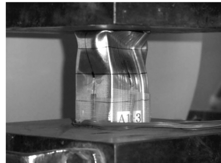
写真 6. 試験体 A-3 終局状況（板厚 0.8mm）
