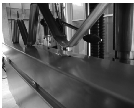
写真 7 試験体の終局状況 (ボルトの破断)
