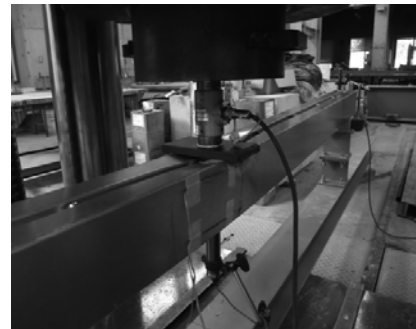
写真6 試験体の終局状況（試験体No.9）
