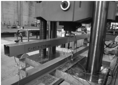
写真5 試験体外観（正方形断面部材）
