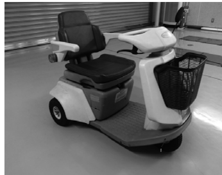
図2 供試したハンドル形電動車いすの外観
