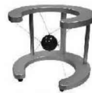
(b)佐藤・小池ら開発した SPIDAR 図1 接地型ハプティックデバイス
