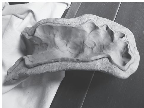
図20 型への粘土詰め
