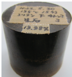
家畜混合糞由来堆肥で作製したバイオコークス (Table 2, 試作 No.3)
