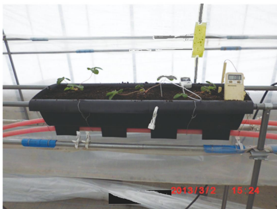
写真5. 温度測定箇所 (g. 栽培地温)
