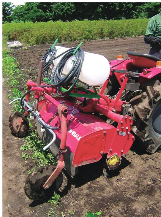
写真2 ロータリー + 液肥注入 + 播種機
