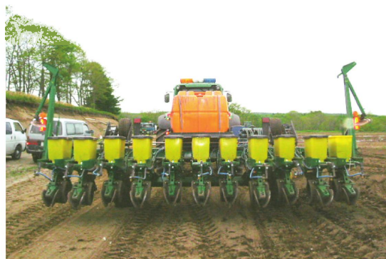
写真1 デントコーンにおける少量液肥栽培用播種機
