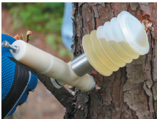
図5 注入ガン試作品による樹幹注入
