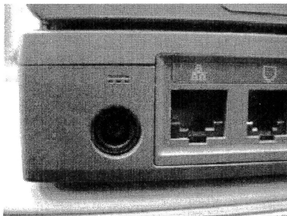
写真1 ACコネクタの正常状態
