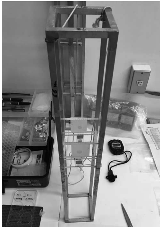
図2 照射用アルミニウムアングルの全体と中央部に設置している照射用金箔セット
