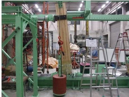
写真 1 I 型試験体 (FRP 有) の終局状況
