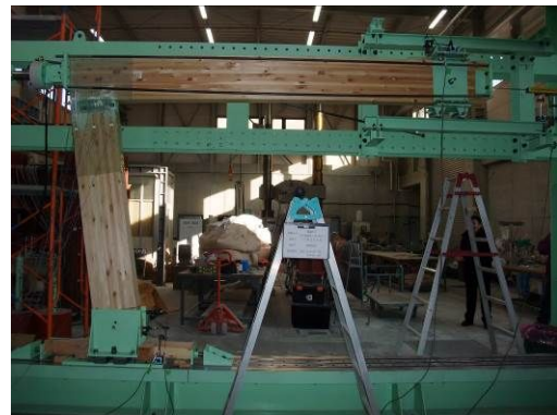
写真 3 L 型試験体 (FRP 有) の終局状況
