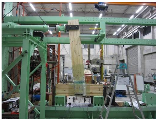
写真 2 T 型試験体 (FRP 有) の終局状況
