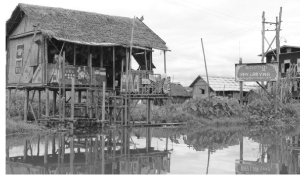
図3 水上住宅外観（椰子葺き・網代壁）
