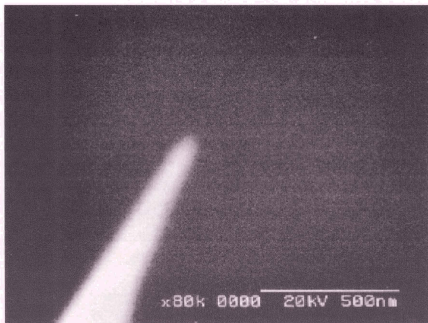
図8 AFM 探針先端部 SEM 写真
