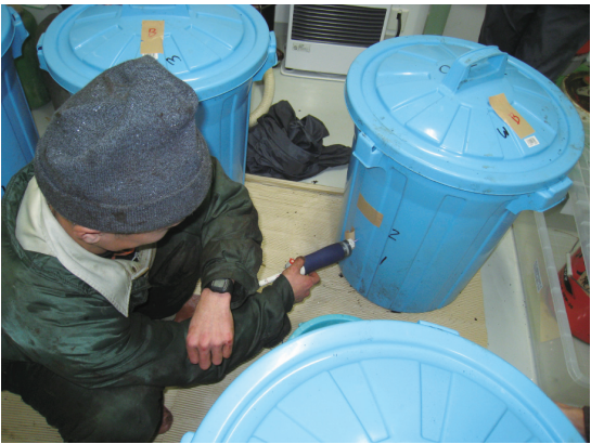
写真1 臭気測定用ポリバケツと臭気測定位置
