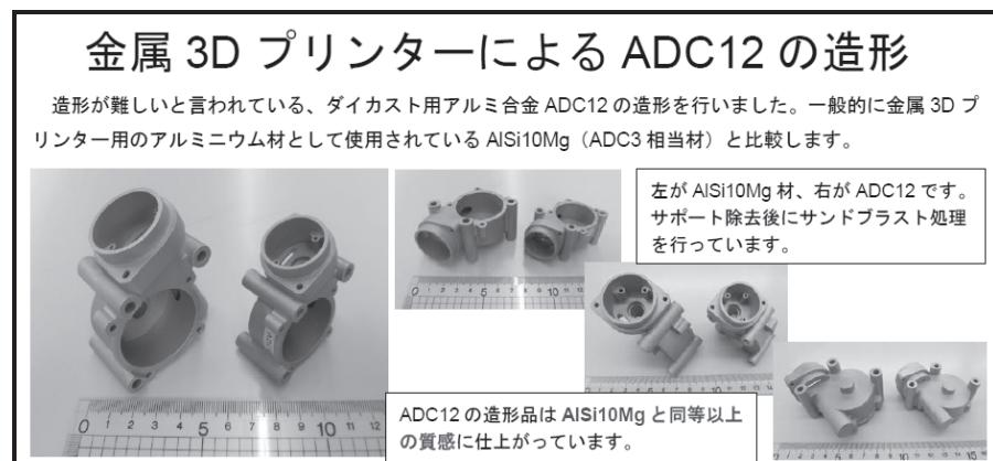
図 7 (株) 仙北谷の金属 3D プリントしたアルミニウム部品
