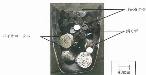
図1 るつばの断面図
