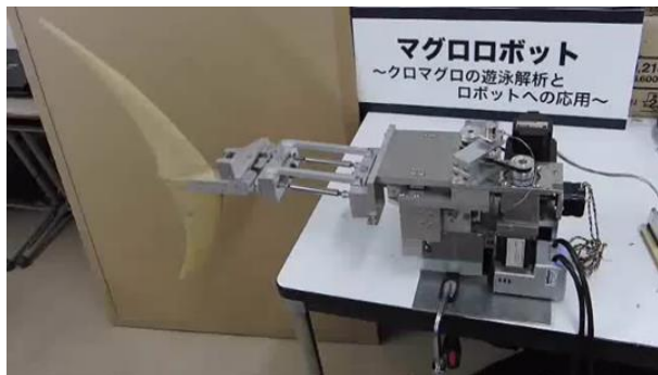
図1 尾ヒレ駆動機構の概観
